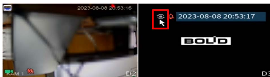
Рисунок 10.14 – Приостановка постоянного обхода
