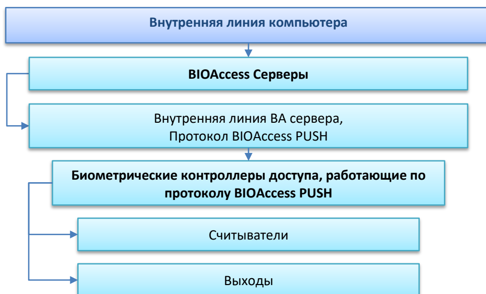
Рисунок 6-72 Схематическое отображение структуры внутренней линия компьютера с интерфейсом TCP/IP и протоколом BIOAccess BAsServer
