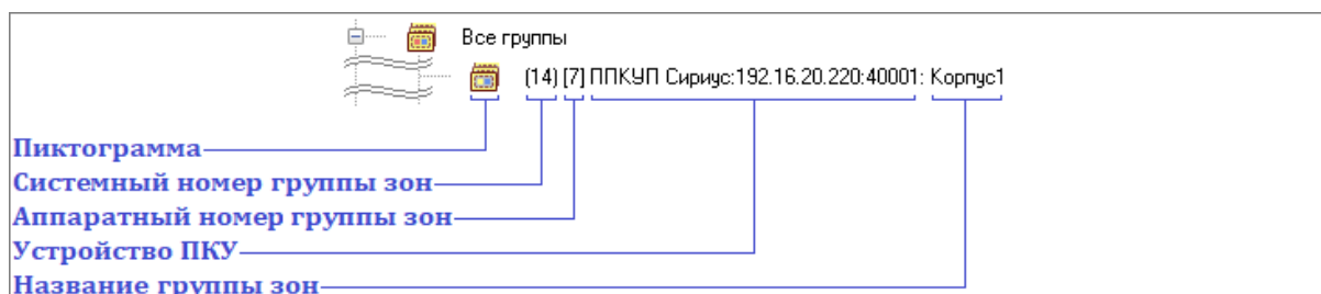
Рисунок 6-260 Отображение объекта "Аппаратная группа зон" в дереве зон как принадлежащего узлу "Все группы"
