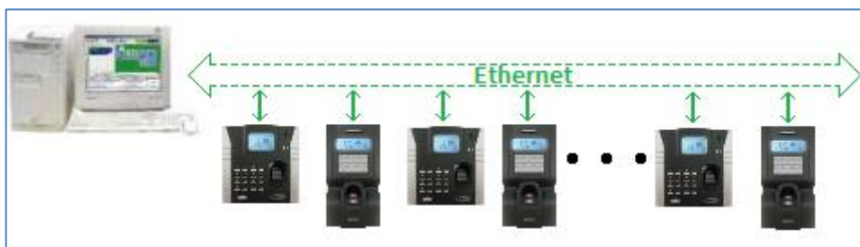
Рисунок 1-14 Схема подключения биометрических считывателей
