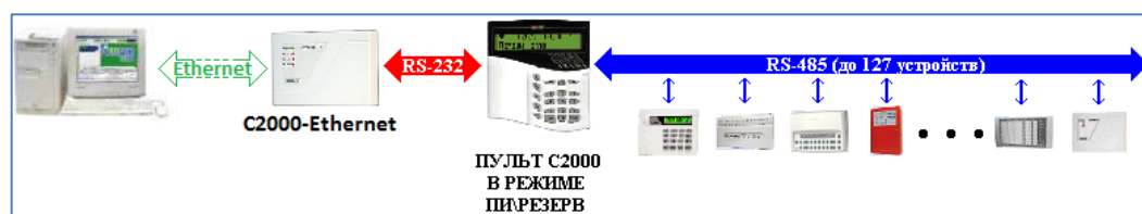
Рисунок 1-10 Схема подключения приборов через Ethernet по протоколу "Орион" с резервированием пультом
