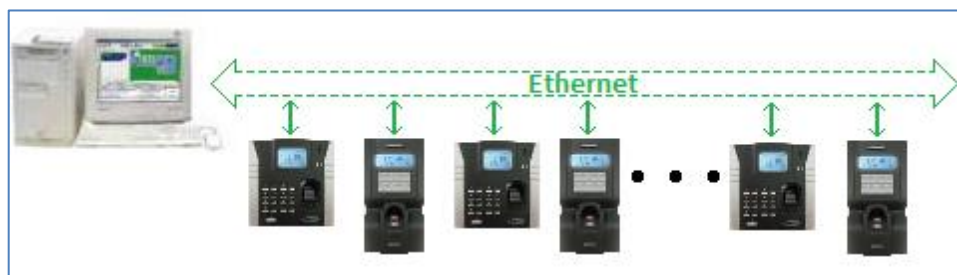
Рисунок 1-14 Схема подключения биометрических считывателей
