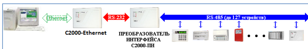
Рисунок 1-9 Схема подключения приборов через Ethernet по протоколу "Орион"
