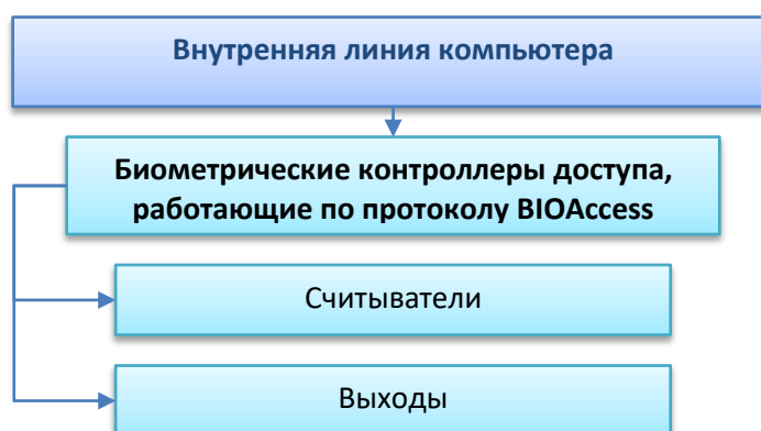
Рисунок 6-73 Схематическое отображение структуры внутренней линии компьютера с интерфейсом TCP/IP и протоколом BIOAccess
