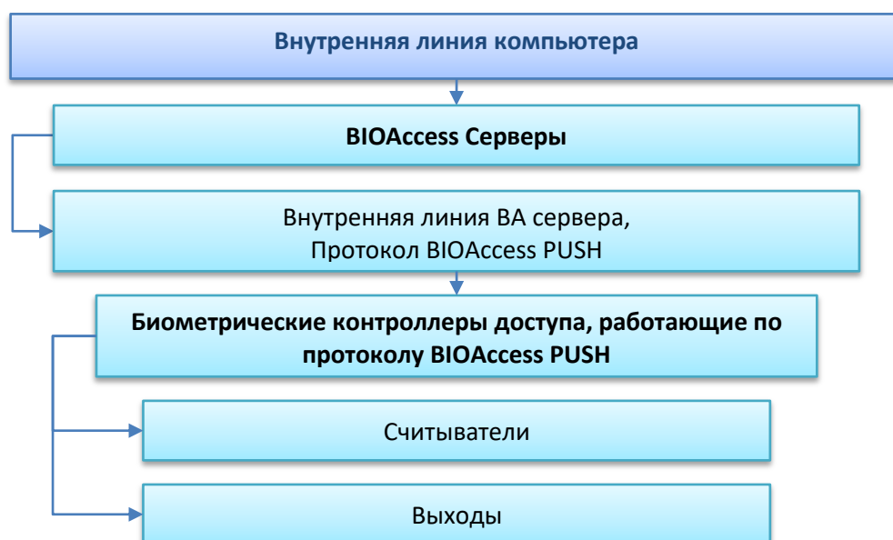
Рисунок 6-72 Схематическое отображение структуры внутренней линии компьютера с интерфейсом TCP/IP и протоколом BIOAccess BAsServer
