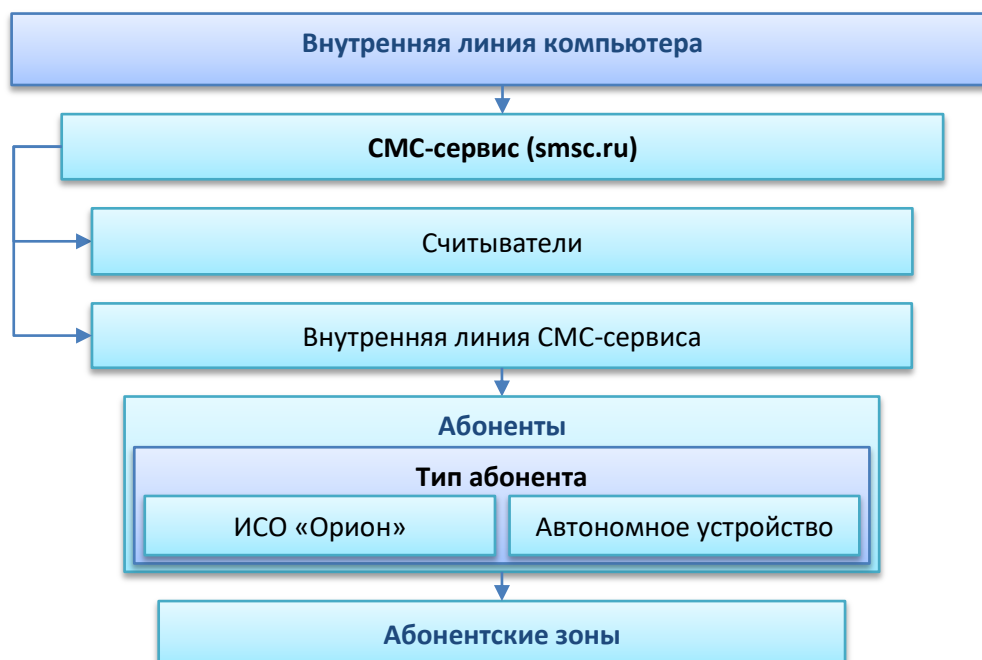
Рисунок 6-70 Схематическое отображение структуры внутренней линии компьютера с интерфейсом TCP/IP и протоколом SMS-шлюз: СМС-сервис (smc.ru)
