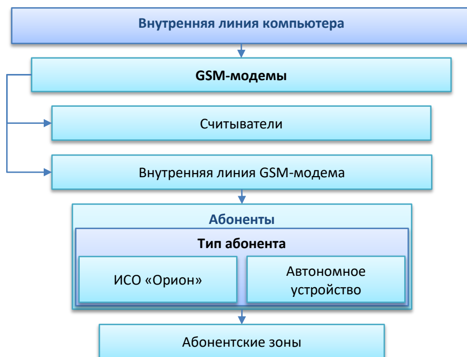
Рисунок 6-68 Схематическое отображение структуры внутренней линии компьютера с интерфейсом RS и протоколом GSM(GPRS) модем
